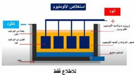
يتم استخراج الألومنيوم من من خام البوكسيت ( $Al_2O_3$ ) المذاب في الكريوليت ( $Na_3AlF_6$ ) بواسطة عملية التحليل الكهربائي في الخلية الإلكتروليتية الموضحة بالشكل.
