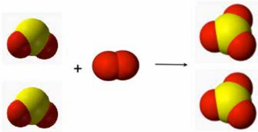
تتكون نتيجة احتراق الوقود الذي يحتوي على شوائب كبريتية فيتكون غاز ثاني أكسيد الكبريت الذي يتأكسد بأكسجين الهواء الجوي بفعل الشوائب التي توجد في الهواء و تعمل كعامل مساعد لتمام هذا التفاعل ويتكون غاز ثالث أكسيد الكبريت.
