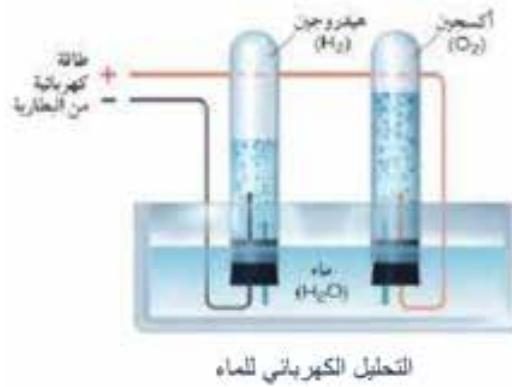
الشرط الأساسي في هذه العملية حتى يكون الهيدروجين أخضرًا أن تكون الكهرباء التي يتم استخدامها في عملية التحليل الكهربائي خالية من الكربون، أي ما يطلق عليها الكهرباء الخضراء، وهي الكهرباء التي يتم إنتاجها من مصادر طاقة متجددة، وأبرزها الماء والرياح والشمس.
