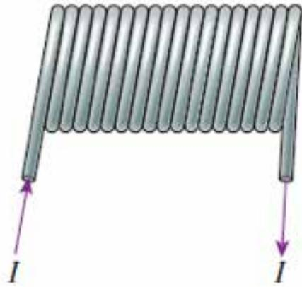
والشكل الذى أمامك يوضح ملف لولبي يتكون من سلك مصنوع من النحاس ذو عدد لفات كبير ملفوف حول ساق من الحديد المطاوع، وعند توصيل طرفى الملف بمصدر كهربى ويبدأ التيار الكهربى (I) فى المرور خلال الملف فيتولد فيض مغناطيسى داخل الملف يعمل على تحويل ساق الحديد إلى مغناطيس شدة مجاله المغناطيسى تعتمد على عدد لفات الملف وشدة التيار الكهربى ونوعيه الساق الحديدى.
