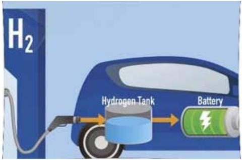
السيارات الهيدروجينية: تعمل خلايا الوقود على تحويل الهيدروجين إلى طاقة كهربائية، مما يقلل استخدام الوقود الحفري وتقل الانبعاثات الكربونية.
