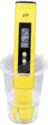
١. المعايرة: قم بمعايرة مقياس الرقم الهيدروجيني وفقاً لتعليمات الشركة المصنعة باستخدام الماء المقطر.
